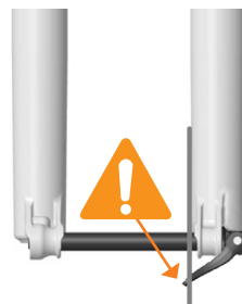
NIEPRAWDŁOWO ZAMONTOWANA OŚ
