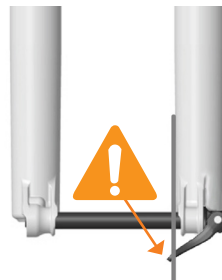
EIXO INSTALADO INCORRETAMENTE
