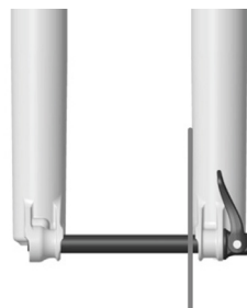
AXE CORRECTEMENT INSTALLÉ
