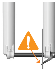
AXE INSTALLÉ DE MANIÈRE INCORRECTE
