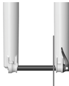
PRAWDŁOWO ZAMONTOWANA OŚ
